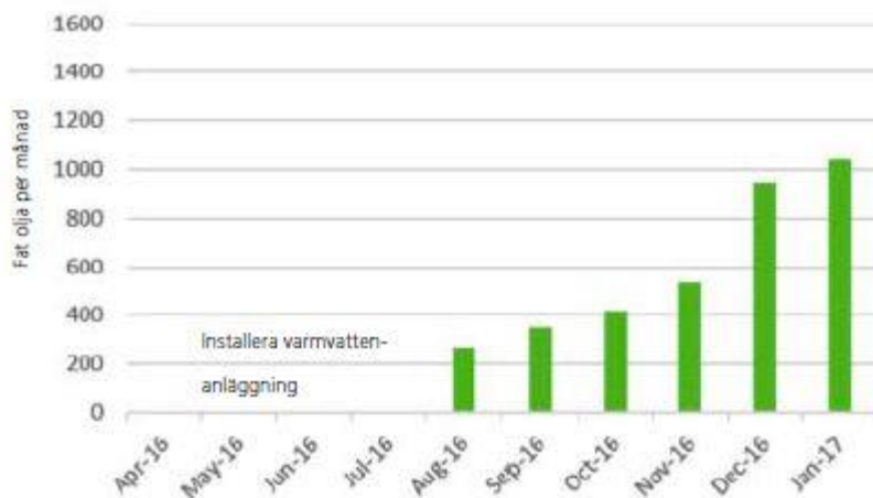
LAK Ranch oljeproduktion från varmvatteninjicering
